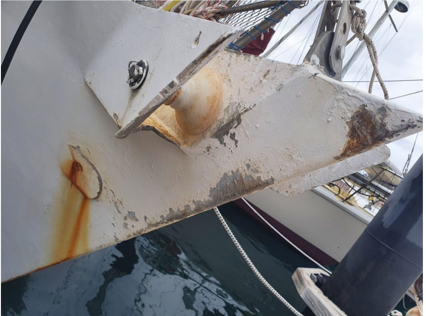
Schäden durch Anker
