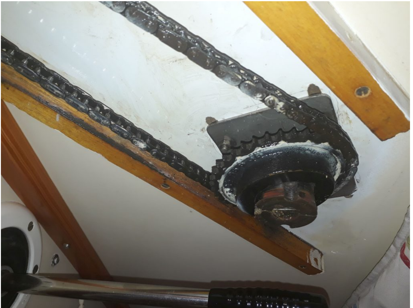
Ritzel Autopilot abgegangen - kurz von Hand steuern
